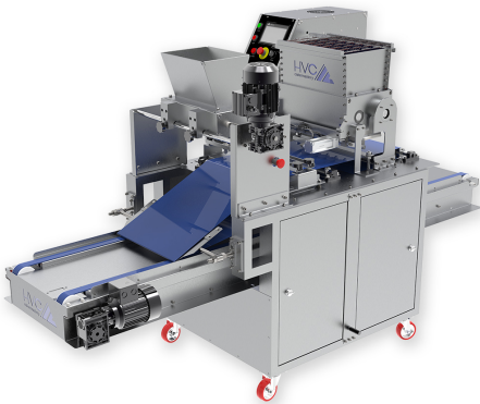
Dolgulu Pasta Makinası (Tek Renkli Marmelat ve Çikolata) Maamoul Production Machine (Monochrome Marmalade + Chocolate) ماكينة إنتاج المعمول (لون واحد + شوكولاتة)
