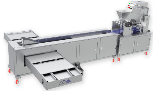
Galeta Makinası Grissini Machine ماكينة جريسيني
